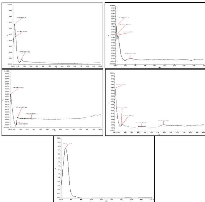
Fig. 3. UV-Visible spectrum for a) NiO b) Ni<sub>0.75</sub>Co<sub>0.25</sub>O c) Ni<sub>0.5</sub>Co<sub>0.5</sub>O d) Ni<sub>0.25</sub>Co<sub>0.75</sub>O e) Co<sub>3</sub>O<sub>4</sub> nano composites.
