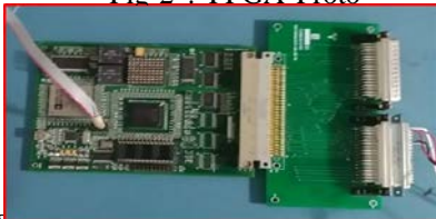
Fig-2 : FPGA Proto
